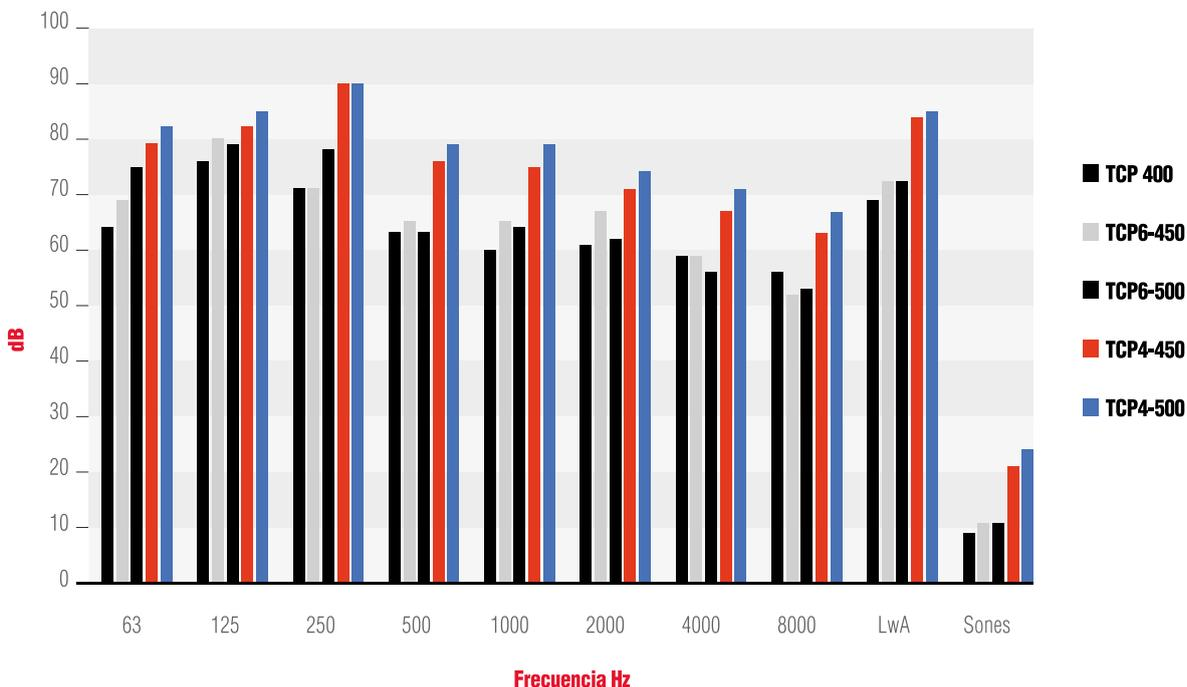
Los valores de potencia sonora (LwA) mostrados fueron realizados en instalación tipo A: Sin ducto en la succión, sin ducto en la descarga. El rango de ponderación A, está calculado con base en el estándar internacional AMCA 301.
